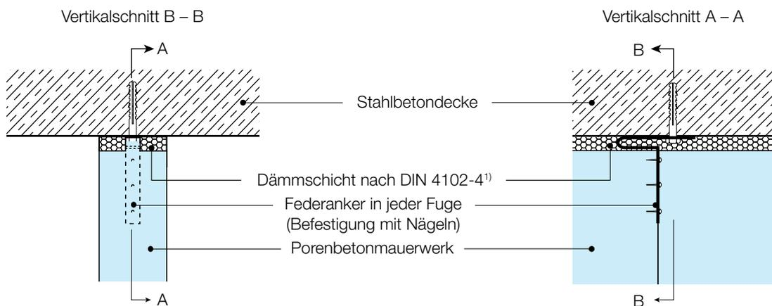
¹) Mineralwolle, nicht brennbar, nicht glimmend, Schmelzpunkt  $\geq 1.000\text{ °C}$ , Rohdichte  $\geq 30\text{ kg/m}^3$
