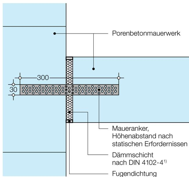
¹) Mineralwolle, nicht brennbar, nicht glimmend, Schmelzpunkt  $\geq 1.000\text{ °C}$ , Rohdichte  $\geq 30\text{ kg/m}^3$
