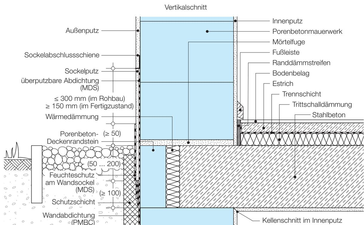
PMBC: Polymermodifizierte Bitumendickbeschichtung
